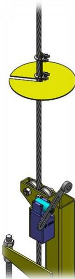
Deve-se instalar o batente fim de curso em ambos os lados a uma altura onde se deseja parar o balancim na parte superior. O mesmo deve ser preso através de 2 prensa cabos, conforme figura ao lado. A distância entre o batente e o ponto de apoio não deve ser menor de 50cm. O cabo no qual ele deve ser instalado é o cabo de tração.
